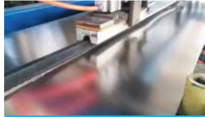
粘贴 V 形胶条 V-rope bonding
